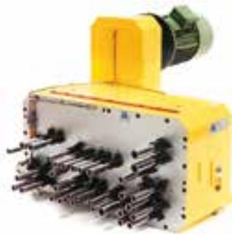
alesatura, fresatura; in questo caso all'interno della testa si hanno due tipi di lubrificazione, ad olio per gli ingranaggi elicoidali ad evolvente rettificato e a grasso per tutti i gruppi mandrino. Anche questa serie si può equipaggiare con maschere guida utensili su colonne mobili o fisse, adduttori per refrigerante passanti per il centro dell'utensile.
